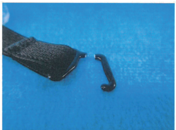
写真5 試験後の破損箇所
